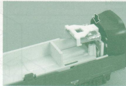
Verbinden sie die Platine mit dem Platinenhalter und dem Decoder. Danach installieren Sie alles zusammen im Wagenende wie in der Abb. gezeigt.
